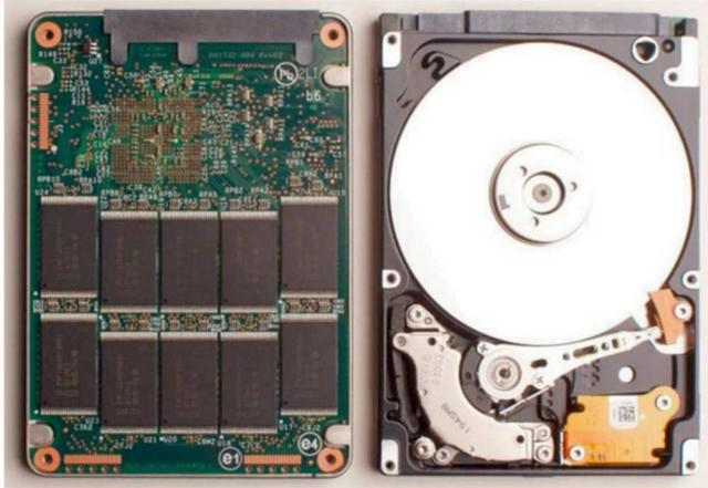
Längst wurde die HDD daher von der SSD überholt, die statt beweglicher Teile die vorteilhafteren Mikrochips einsetzt.
